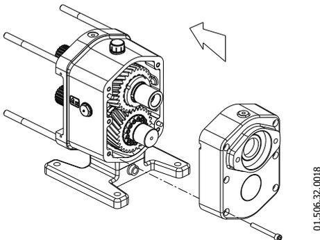
Vérifiez que le joint du couvercle des roulements (18) n'a pas été endommagé, et montez-le à la position correcte du couvercle des roulements(12) avec du bouche-pores.
