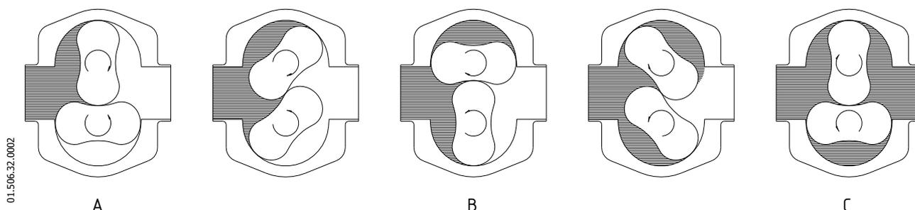
**A** : lorsque les lobes tournent, l'espace du côté aspiration augmente, car un lobe s'éloigne de l'autre, causant un vide partiel qui conduit le liquide vers la chambre de pompage.
