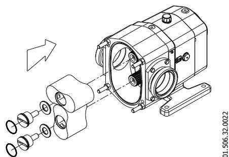
Montez les joints toriques neufs (80 et 80D) sur les vis des lobes (25) et sur les axes (05 et 05A).
