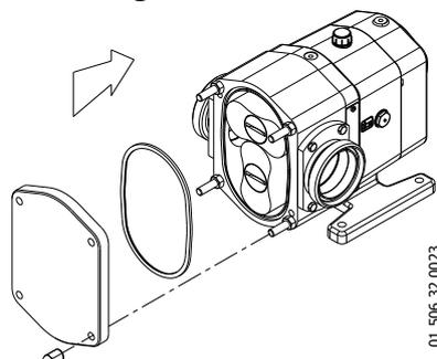
Vérifiez que le joint (80A) se trouve en bon état, ou remplacez-le par un joint neuf si nécessaire.
