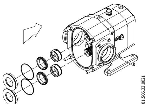
Montez la partie rotative de la fermeture mécanique (08) jusqu'à ce qu'elle bute contre l'axe et serrez les goujons de la partie rotative de la fermeture mécanique (08).
