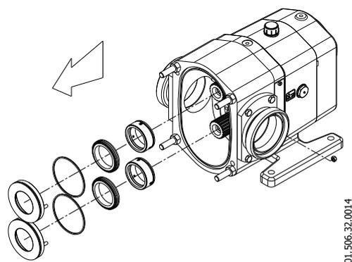
Desserrez les écrous (57) qui fixent chaque couvercle de fermeture (09). Veillez à ce que ces écrous soient vissés de quelques tours dans le goujon.
