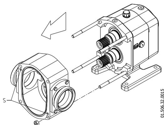
Desserrez et retirez les écrous (54) qui fixent le corps (01) au support des roulements (06).
