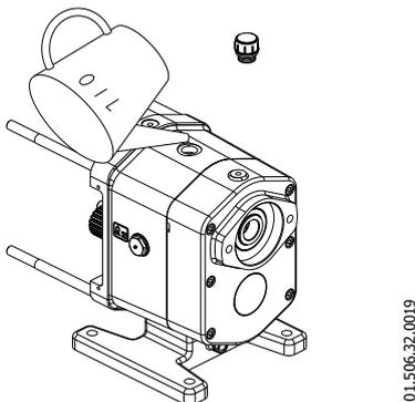
Retirez le bouchon d'huile (85) situé sur la partie supérieure du support de roulements (06).
